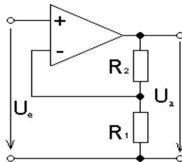
Gleichspannung:  $\omega = 0$ ; Grenzfrequenz:  $\left| \frac{U_a}{U_e} \right| = v_0 \frac{1}{\sqrt{2}}$ , wobei  $v_0$  Gleichspannungsverstärkung
