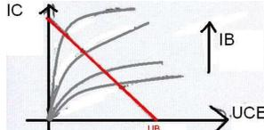
Zwei der folgenden Werte eintragen und als Gerade verbinden: (i) Arbeitspunkt ( $I_C$  und  $U_{CE}$ ), (ii)  $\frac{U_B}{R_C}$  bei  $U_{CE} = 0$ , (iii)  $I_C = 0$  und gegebenes  $U_B$  als  $U_{BE}$ .
