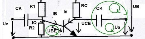
**I:** Knotenregel liefert  $I_1 = I_Q + I_B$ . Maschenregel liefert  $U_1 + U_B - U_{BE} = 0 = (I_Q + I_B) \cdot R_1 + U_B - U_{BE}$
