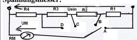
Wahl von  $R_1, R_2, R_3$ ?: **A:** kein Vorwiderstand notwendig, **B:**  $U_{ein} - U_M = U_{ein} \cdot \frac{R_1}{R_1 + R_2 + R_3 + R_4} \Leftrightarrow R_1 = \frac{U_{ein} - U_M}{U_{ein}} \cdot R_1 + R_2 + R_3 + R_4$ , **C:**
