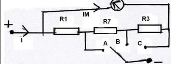
Wahl von  $R_1, R_2, R_3$ ?: **C:**  $I_M = I_C \cdot \frac{R_1 + R_2 + R_3}{R_1 + R_2 + R_3 + R_M} \Leftrightarrow R_1 + R_2 + R_3 = \frac{I_M}{I_C - I_M} \cdot R_M \Leftrightarrow R_1 + R_2 + R_3 = \frac{1}{\frac{I_C}{I_M} - 1} \cdot R_M$
